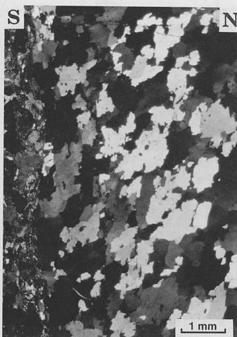
Fig. 2 - Vena di quarzo ricristallizzata dinamicamente in una tonalite foliata. (Passo S. Jorio). L'angolo esistente fra la foliazione della tonalite (verticale) e la direzione di allungamento dei cristalli di quarzo indica un senso di taglio corrispondente al sollevamento del blocco settentrionale rispetto a quello meridionale.
